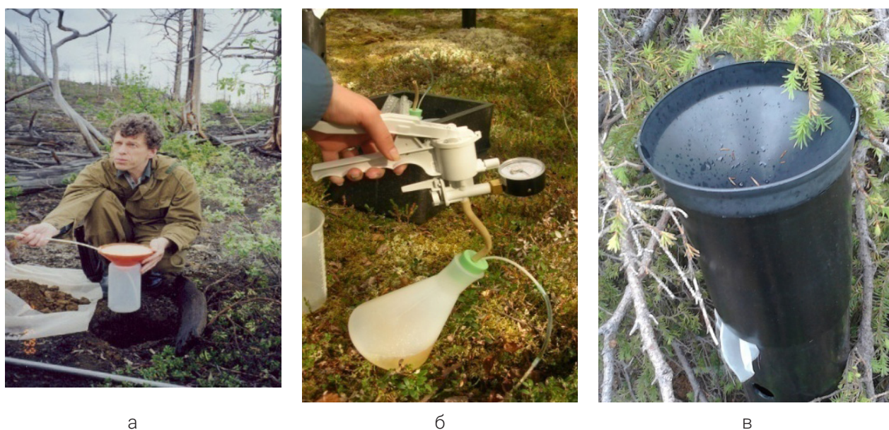
Рис. 3. Оборудование на площадках постоянного наблюдения: а и б – почвенный лизиметр (для сбора почвенных вод); в – осадкоприемники (для сбора дождевых вод), коллекторы (для сбора древесного опада)
