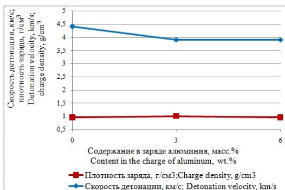
Рис. 3. Изменение скорости детонации зарядов гранулитов на гранулированной аммиачной селитре в зависимости от содержания порошка алюминия ПА-4
