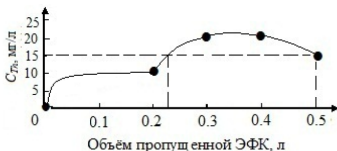
Рис.42. Изменение концентрации тория в сорбате при сорбционном извлечении РЗЭ из ЭФК (пунктиром – концентрация ThO_2 в исходной ЭФК)
