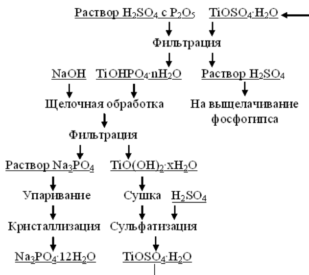
Рис.38. Принципиальная схема регенерации загрязненного фосфат-ионом сернокислого раствора
