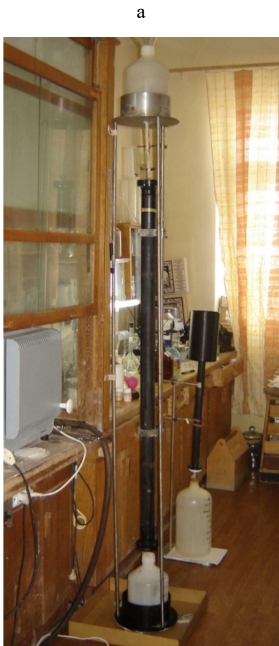
Рис.26. Общий вид (а) и принципиальная схема (б) укрупненной установки для выщелачивания ФДГ
