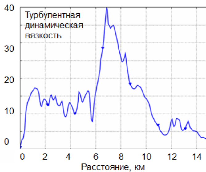
Рис. 3.18. Распределение коэффициента турбулентной динамической вязкости (Па·с) в центральном вертикальном сечении модели (+1 м над пылящей поверхностью) для района модели «хвостохранилище АНОФ-2 — г. Апатиты» (высота пляжа хвостохранилища 200 м)
