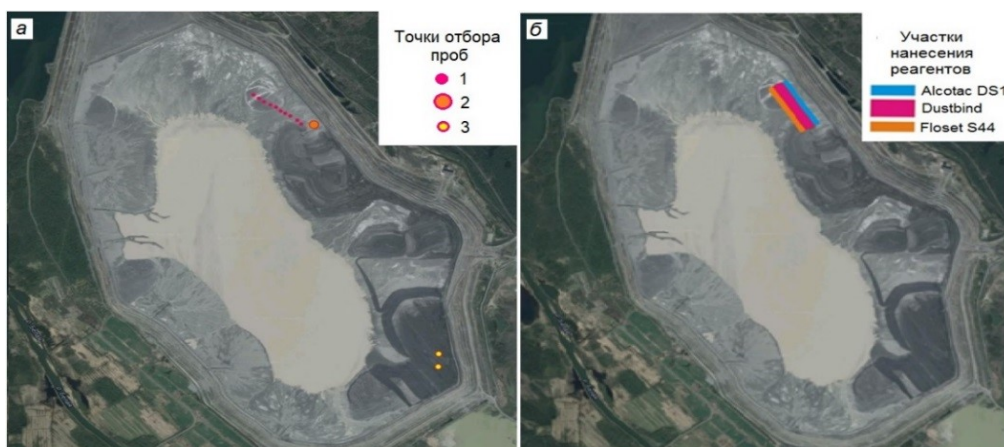
Рис. 1.12. Точки отбора проб хвостов (а), экспериментальная площадка с участками, обработанными связующими реагентами (б). Точки отбора проб хвостов с поверхности (1), хвостов в шурфе на 1,5 м с шагом 0,5 м (2), недавно намывных хвостов с поверхности и глубины 0,7 м (3)
