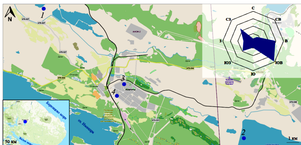
Рис. 2.1. Карта-схема расположения пляжей хвостохранилищ апатит-нефелиновых руд (1, 2), точек отбора атмосферной пыли на участке мониторинга (3) и фоновой пыли (4), (карта-схема дополнена «розой ветров» за бесснежный период 2022 г.). Построение карты-схемы выполнено с применением программного продукта ArcGIS Online
