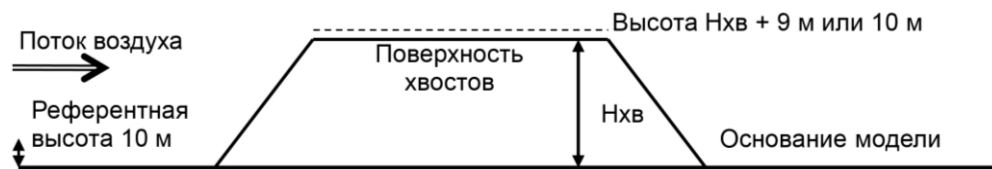
Рис. 3.23. Схема модели под обоснование методики определения интенсивности пыления
