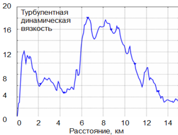
Рис. 3.16. Распределение коэффициента турбулентной динамической вязкости (Па·с) в центральном вертикальном сечении модели (+1 м над пылящей поверхностью) для района модели «хвостохранилище АНОФ-2 — г. Апатиты» (высота пляжа хвостохранилища 180 м)
