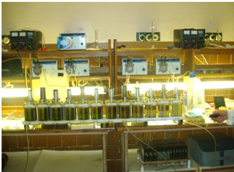
Рис. 18. Внешний вид лабораторной экстракционной установки ЭСОТ-0,0032-0,0004 (конструкции и производства ИХТРЭМС КНЦ РАН)
